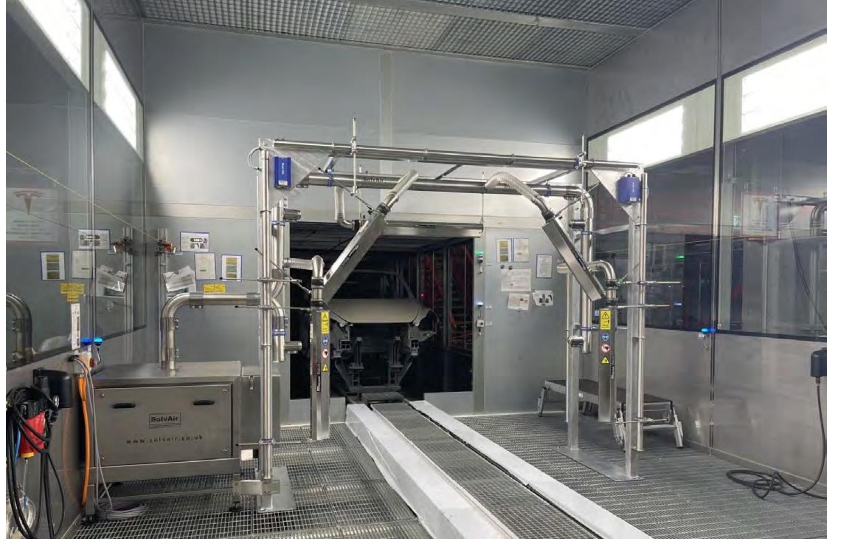
Araç Boyama Sonrası Blowerlı Kurutma Sistemi
